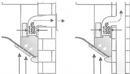
Отводимый воздух подается вверх через вентиляционную шахту или непосредственно через наружную стену за пределы помещения.
