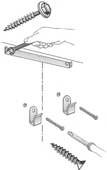
6. Подвесьте вытяжку. Выровняйте ее по высоте и по горизонтали с помощью регулировочных винтов.
