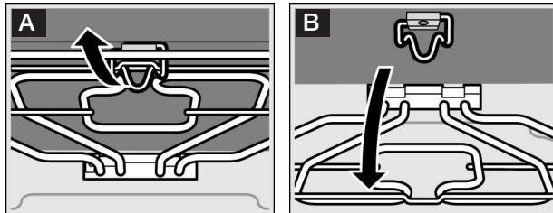
По окончании очистки установите нагревательный элемент гриля обратно в верхнее положение. Откиньте скобу и зафиксируйте нагревательный элемент гриля.
