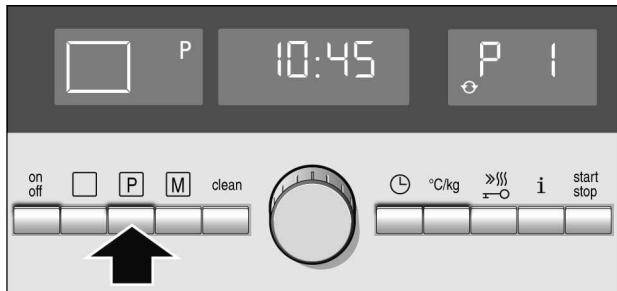
2. С помощью поворотного переключателя установите нужный номер программы.
