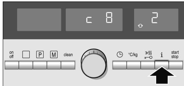
3. С помощью поворотного переключателя измените значение базовой установки.
