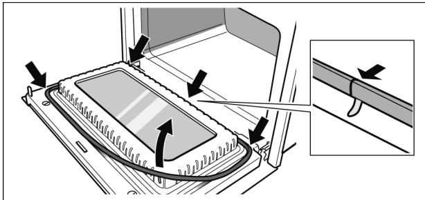
Указание: стык концов уплотнителя дверцы внизу посередине технологически обусловлен.
