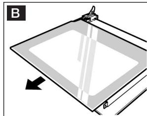
4. Отвинтите винты креплений справа и слева. Приподнимите стекло и отодвиньте от него крепления (рис. С). Выньте стекло.
