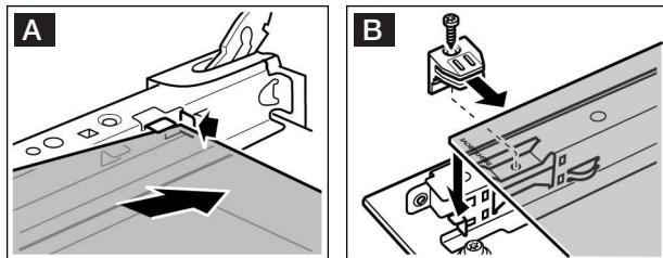
3. Наклоните верхнее стекло и вставьте его движением назад. Гладкая поверхность должна быть снаружи.
