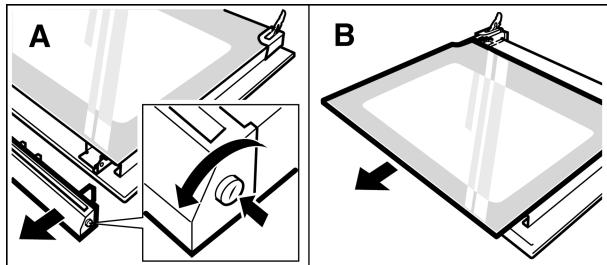
2. Відгвинтіть захисну панель зверху на дверцях приладу. Для цього відкрутіть гвинти зліва та справа. (мал. А)
