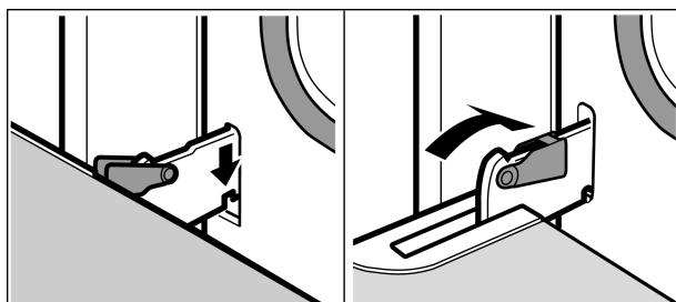
1. Вставте шарніри дверцят прямо в отвори зліва і справа у робочій камері. Виймка на шарнірі повинна зафіксуватись з обох боків.
