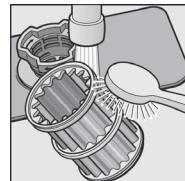
Промойте фильтры в проточной воде.
