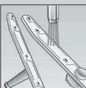
Промийте отвір для розбризкування води у проточній воді (при необхідності скористайтесь зубочисткою)...
