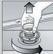
Обертаючи фільтруючий циліндр, витягніть систему фільтрів...
